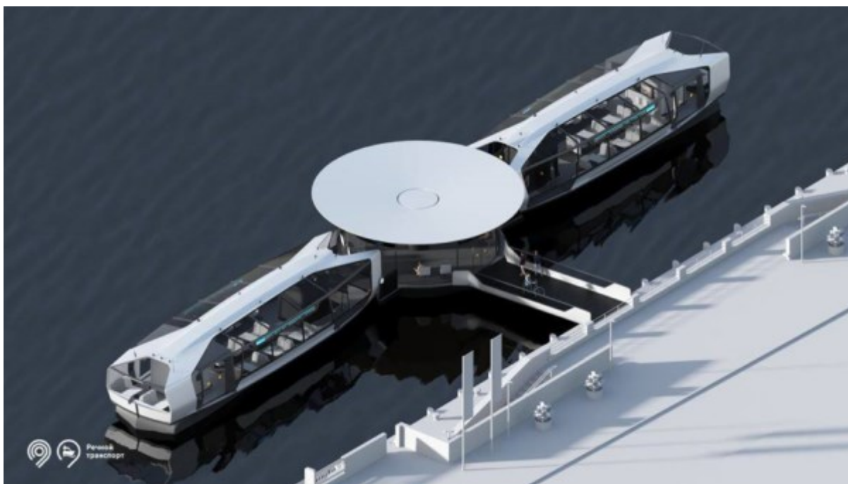
Рис. 2. Электрические трамваи «Синичка» подзаряжаются электричеством на причале.
